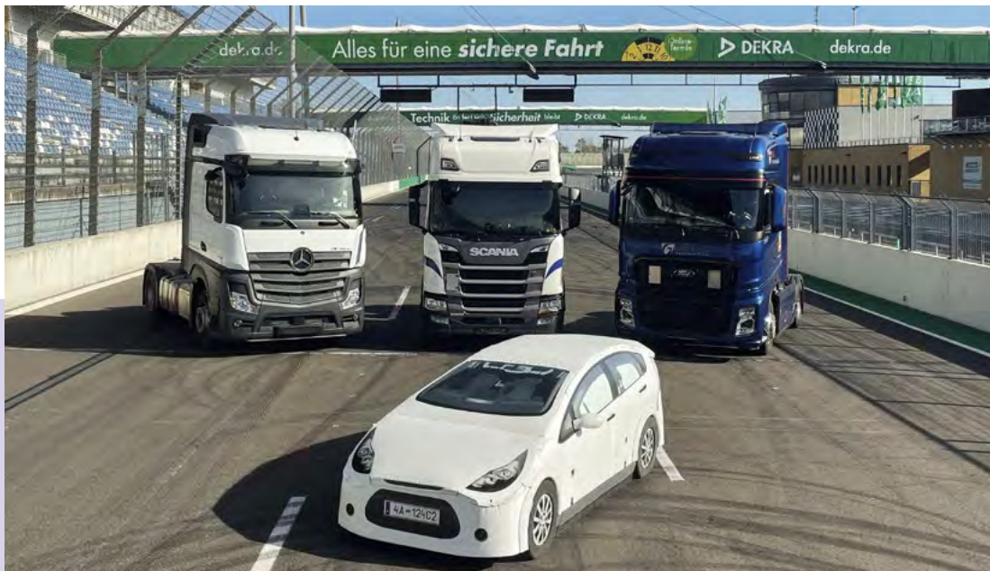
En el marco de una prueba práctica con cabezas tractoras de tres fabricantes de camiones, DEKRA examinó la efectividad de los asistentes de frenado de emergencia incorporados en estos vehículos.
