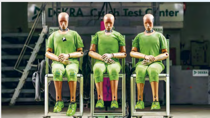
Los maniqués se juegan «la cabeza» en interés de la seguridad vial y albergan instrumentos de medición de alta sensibilidad.
