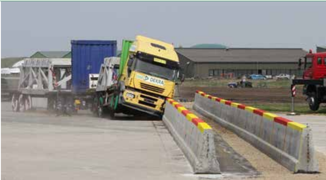
■ Pruebas de choque prolongadas de camiones realizadas por DEKRA en nombre del Instituto Federal de Caminos y Carreteras: el camión de 38 toneladas de longitud no rompió la barrera de seguridad de hormigón de doble capa del nivel de contención más alto.
