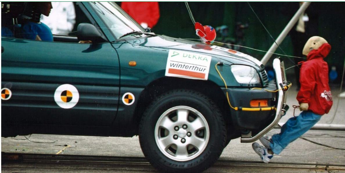
■ En 2000, DEKRA examinó en una simulación de accidente qué riesgos entrañan las defensas frontales y la parte frontal angulosa de los vehículos todoterreno, especialmente, para los niños.
