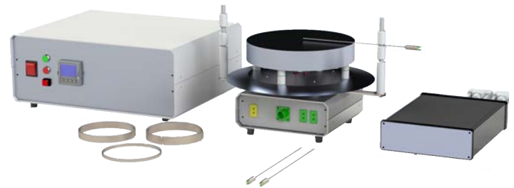
Layer Ignition test apparatus
