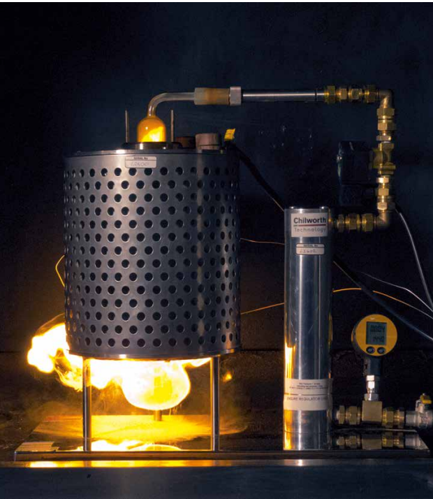
Minimum Ignition Temperature Test (MIT)
