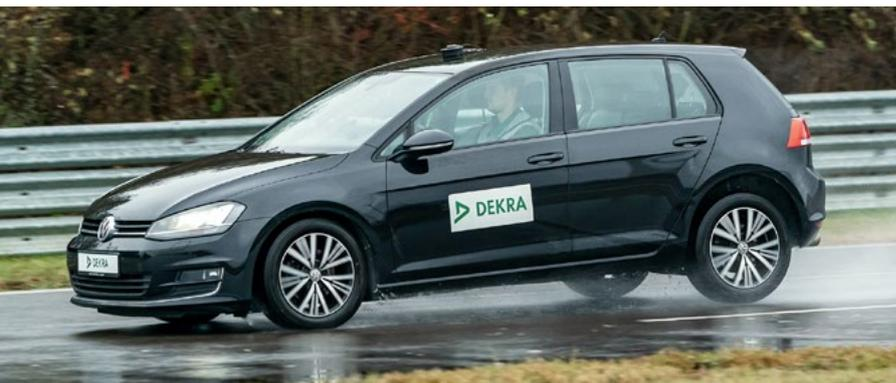
da foi praticamente constante com 44,4 metros. A seguir, os pneus, os travões e os amortecedores foram substituídos por novos. Os pneus foram substituídos por pneus de inverno novos de uma marca premium. A distância de travagem pôde assim ser reduzida para 38,7 metros em média.
